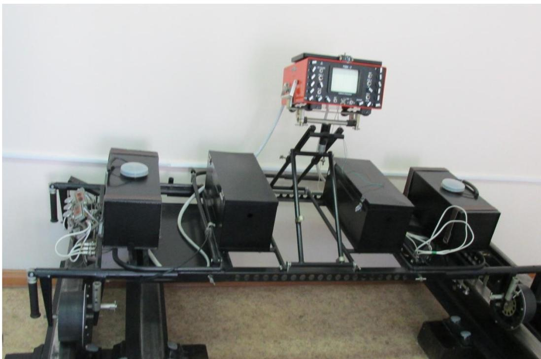
Рисунок 56. Ультразвуковой дефектоскоп РДМ-2
