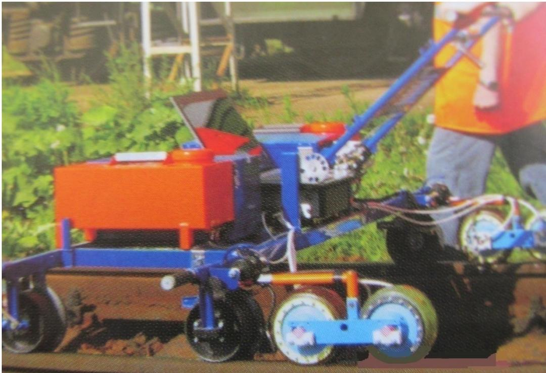
Рисунок 55. Ультразвуковой дефектоскоп АВИКОН-14
