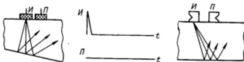
Рисунок 21. При непараллельных поверхностях донный сигнал отсутствует.
