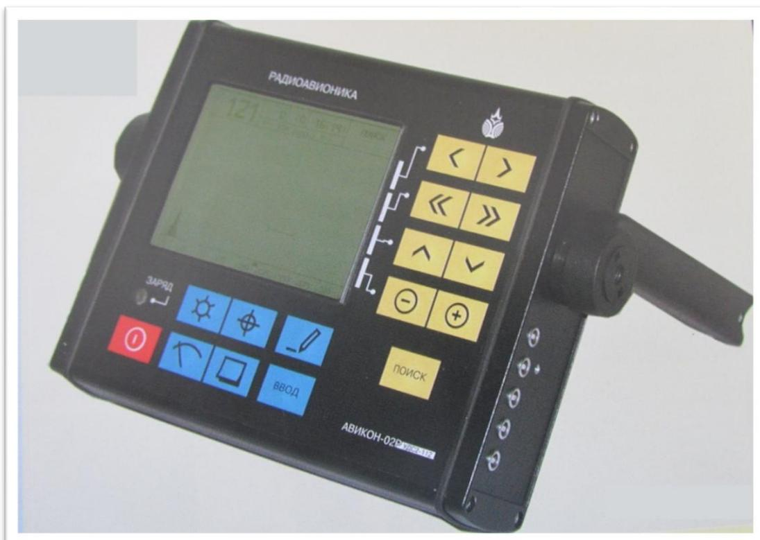
Рисунок 48. Ультразвуковой портативный дефектоскоп АвиКон-02Р
