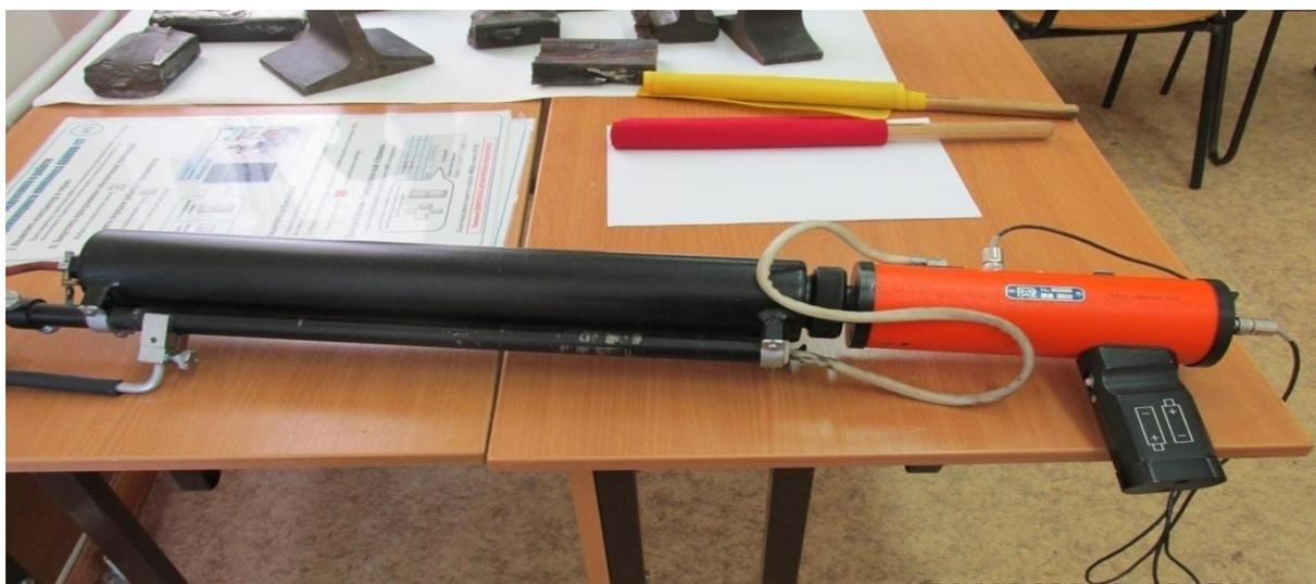
Рисунок 46. Однониточный ультразвуковой дефектоскоп РДМ-1
