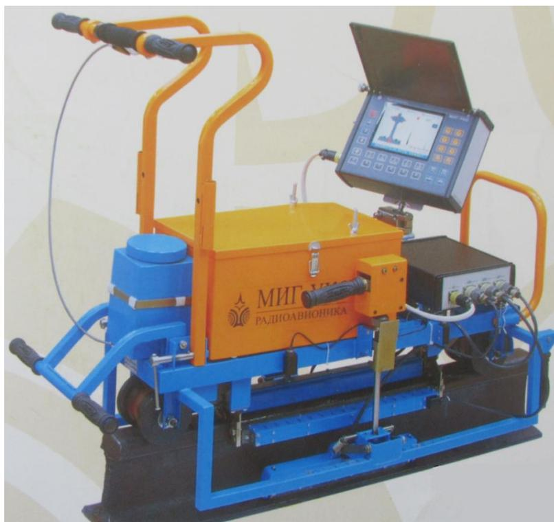
Рисунок 49. Дефектоскоп ультразвуковой МИГ-УКС
